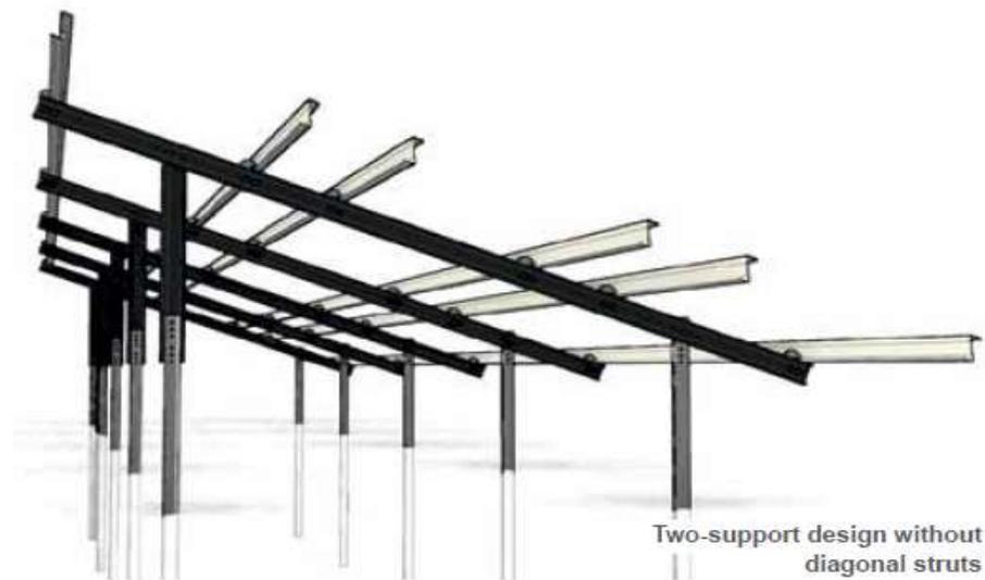
Las estructuras de acero deberán ser galvanizadas en caliente. La galvanización deberá realizarse para todos los perfiles. El espesor del revestimiento de zinc debe calcularse teniendo en cuenta la condición del medio ambiente como en [EN ISO 9223]. La tabla 2 muestra el desgaste anual del recubrimiento para los distintos ambientes climatológicos. Una vida de diseño mínimo de 25 años debe ser considerada para todas las estructuras de la Planta, a menos que se especifique lo contrario.
